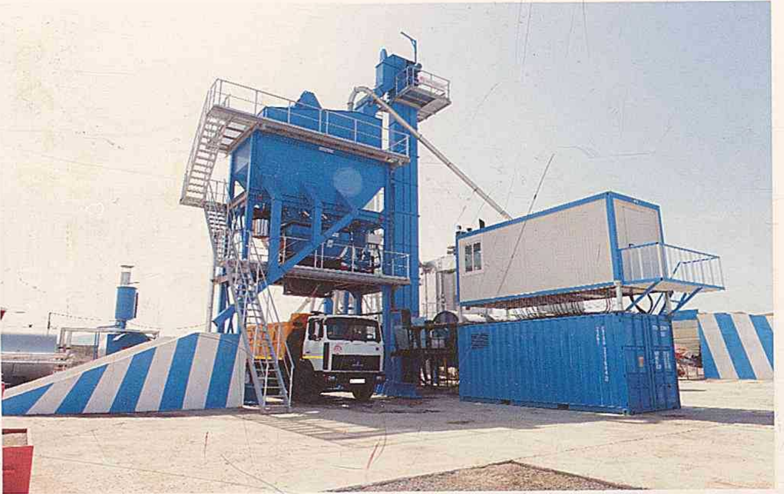
Naxçıvan Şəhər Abadlıq və Təmir-Tikinti İdarəsində istehsal gücü saatda 125 ton olan Asfalt-Beton Zavodu
