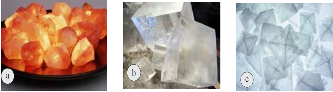
Şəkil 1. a) duz kristalları; b) kristalların kubik formaları; c) NaCl kristalında dekorativ torun dislokasiyası
